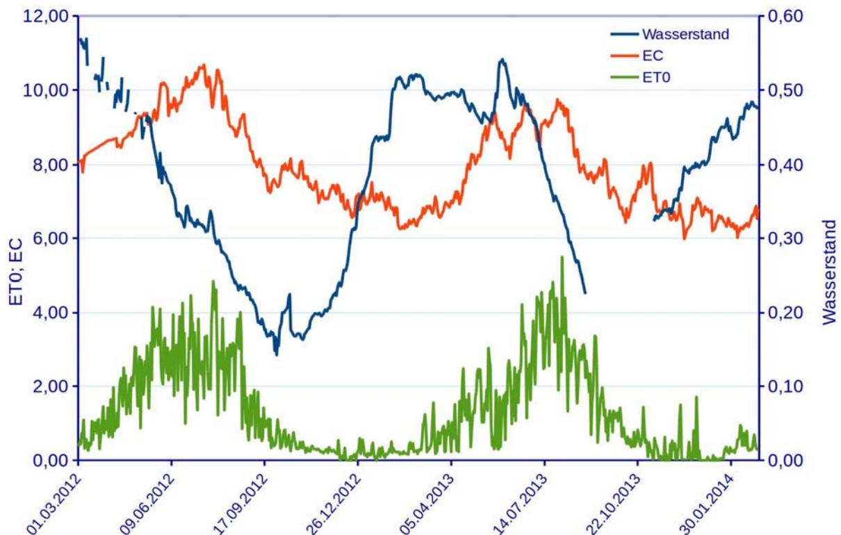
Abb. 3: 2-jährige Ganglinien von Wasserstand (in m HN), elektrischer Leitfähigkeit (EC in mS/cm) und Grasreferenzverdunstung ET0 (in mm/d) an einer Messstelle in der Niederung in der Mitte zwischen zwei Gräben.
