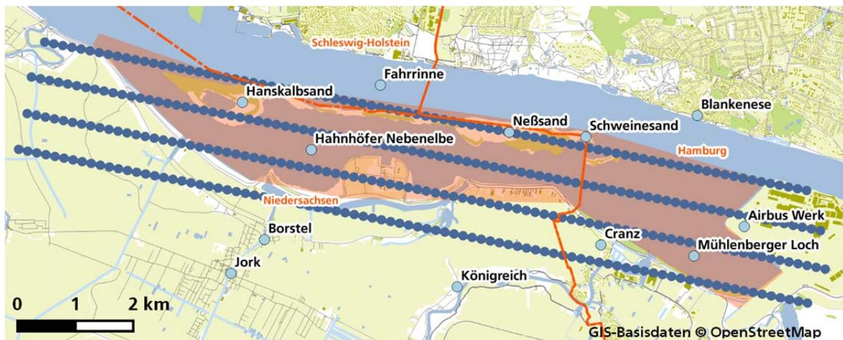
Abb. 3: Übersicht über das Befliegungsgebiet (hellrot überlagert) und die Fluglinien mit den Auslösepunkten der Kameras.
