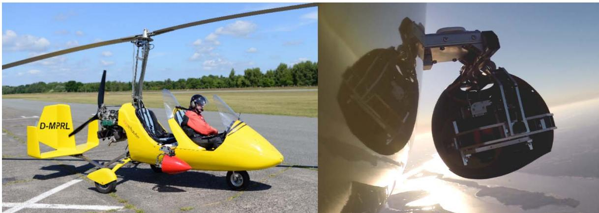
Abb. 2: links: eingesetzter Tragschrauber mit eingebauter Sensorik, das PanTIR-System ist im roten Windabweiser geschützt montiert; rechts: Aufnahme des Systems im Flug.
